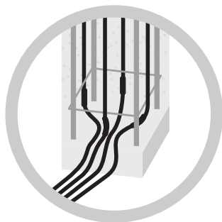
Ułożenie przewodów grzejnych w filarze betonowym
