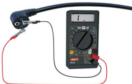
Измерение сопротивления токопроводящей жилы
