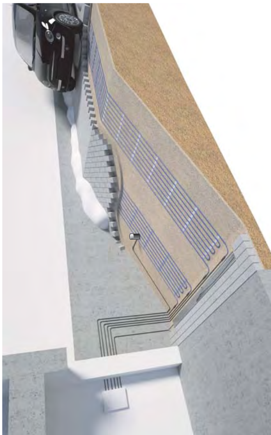
Przykład ułożenia przewodów grzejnych ELEKTRA VC w podjeździe do garażu wykonanego z kostki brukowej
