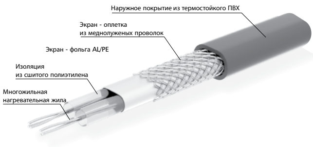
Конструкция нагревательного кабеля ELEKTRA VCD
