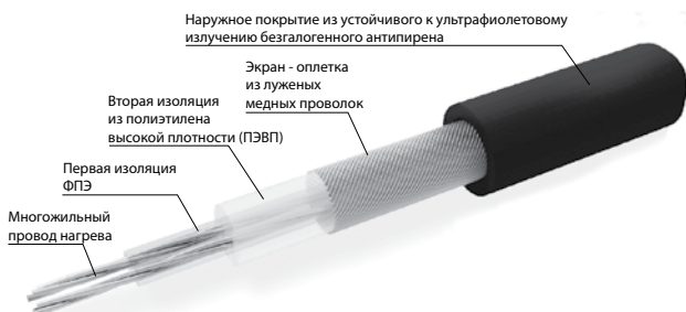
Конструкция кабеля нагревательного мата ELEKTRA SnowTec ® Tuff
