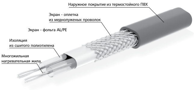
Конструкция нагревательного мата ELEKTRA SnowTec®
