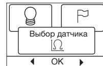
Выберите установленный датчик при помощи кнопок со стрелками и подтвердите установку нажатием **OK**. На дисплее появятся характеристики сопротивлений датчика для температур  $15^\circ\text{C}, 20^\circ\text{C}, 25^\circ\text{C}$  и  $30^\circ\text{C}$ .
