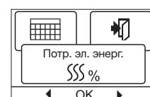
Нажмите кнопку **OK** для выбранного периода. Значение в процентах (%) показывает относительное время, когда система обогрева была включена. Следующая цифра показывает расходы за выбранный период. Для того чтобы обеспечить правильность расчета, следует выбрать настройки валюты, стоимости кВтч и нагрузки.
